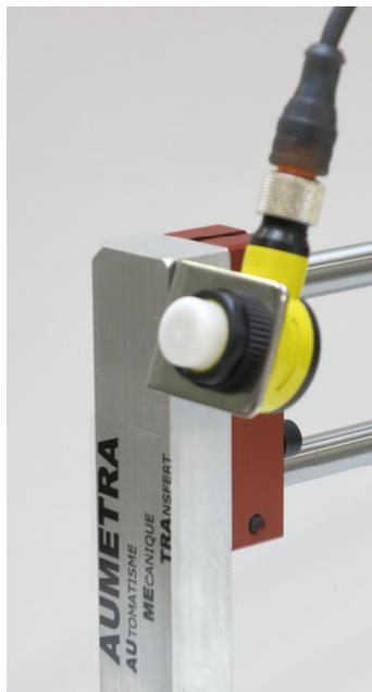
Fixation du voyant de contrôle de la pression dans le vérin pneumatique.
